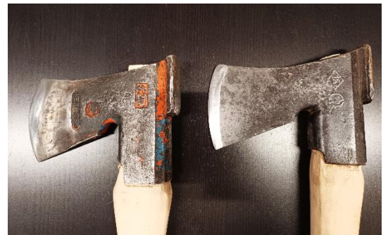
Kuva 1: vasemmanpuoleisen kirveen terä on teroitettu liian pyöreäksi. Oikeanpuoleisessa kirveessä kaari on loivempi ja toimivampi.
